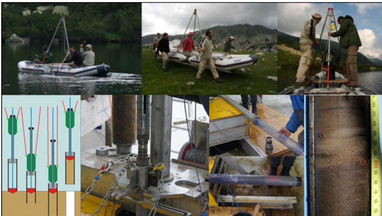
6. ábra Livingstone-típusú tavi fúróberendezés működés közben, és a fúró működési elve (bal alsó kép). A fúrót leggyakrabban csónakra vagy platformra épített állványzatról működtetjük, és a fúró fejlettebb változatai műanyag bélésű csőbe veszik a mintát, mely a fúrást követően flexsel kerül felnyitásra. A jobb alsó kép tipikus tavi furat mintát mutat.
